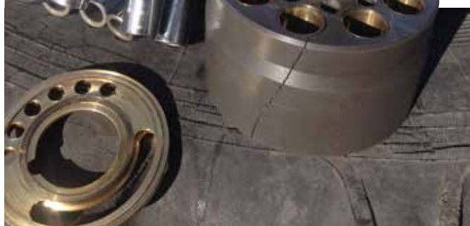
Последствия использования неоригинального блока цилиндров аксиально-поршневого насоса A4VG компании Bosch Rexroth
